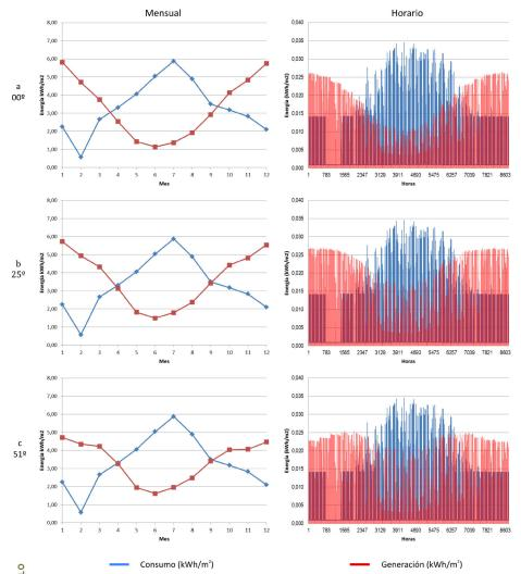
Figura 4. Consumo y generación de energía eléctrica (kWh/m²) para período anual, según diferente valor de inclinación de paneles fotovoltaicos (fuente: Elaboración propia).
